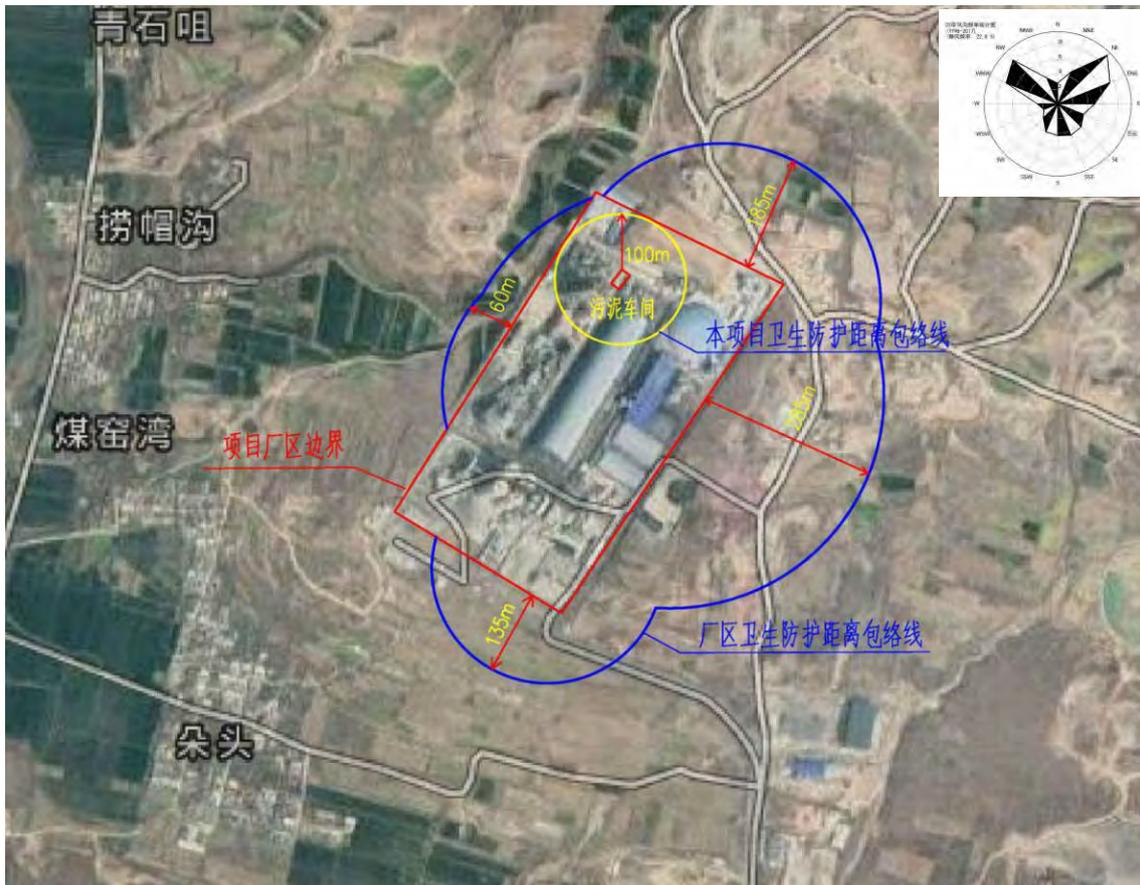
图 6-23 本项目及本项目建成后全厂卫生防护距离包络线图
