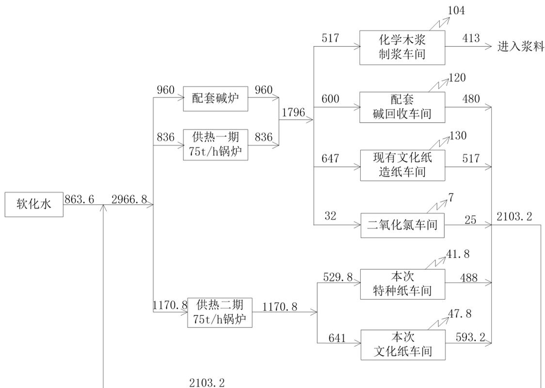
图 3.3-1 本次工程完成后全厂蒸汽平衡图
