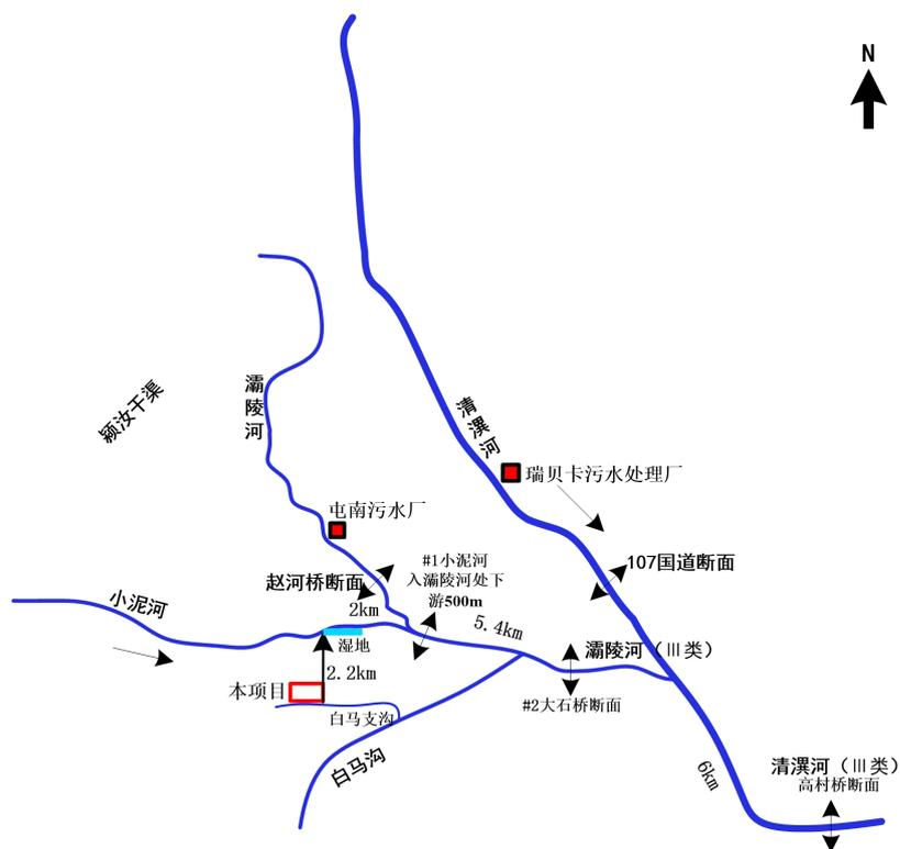
图 5.2-1 本次工程排水路线及区域污染源分布示意图
