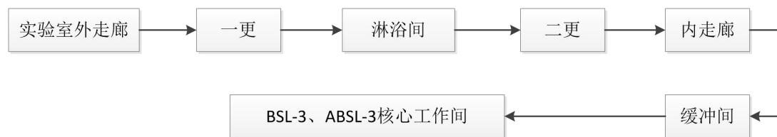
图 2.8-3 生物安全三级实验室气压梯度
