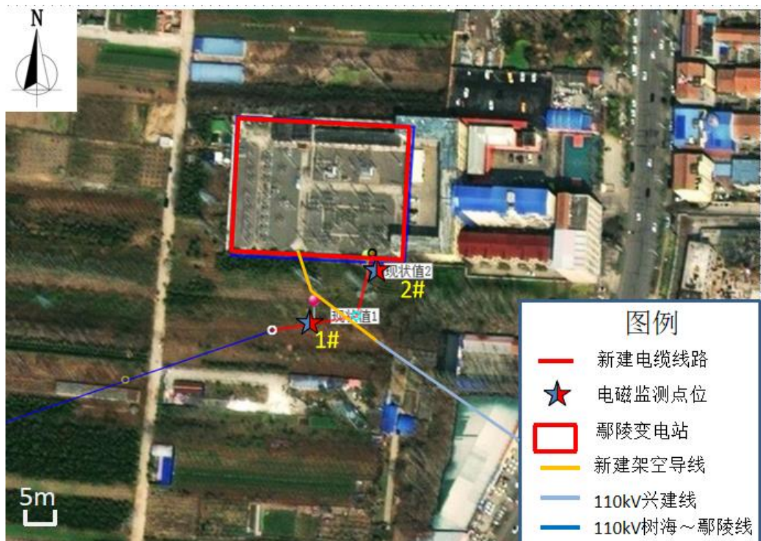
图 7 树海~郾陵 \pi 入汶河变 110kV 线路工程背景现状监测布点示意图
