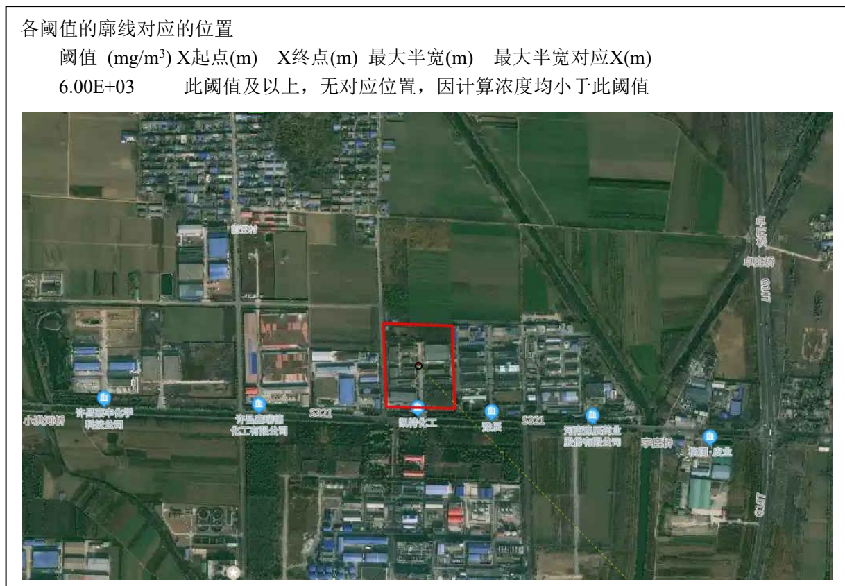
图 5.3-5 稳定度 F 情况下乙酸乙酯泄露下风向各点计算浓度最大影响范围
