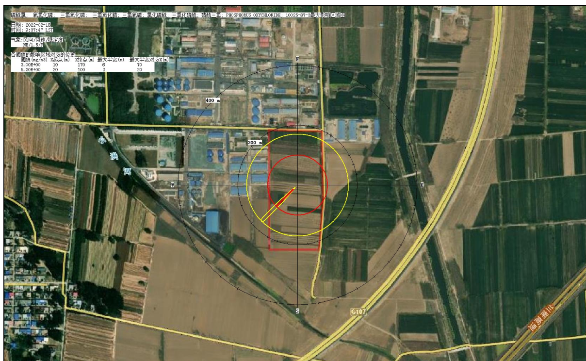
图 6.7-5 最不利气象条件下管线 POCl 3 泄漏事故最大影响范围图
