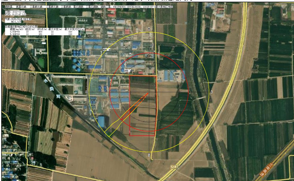
图 6.7-3 最常见气象条件下反应釜 POCl 3 泄漏事故最大影响范围图
