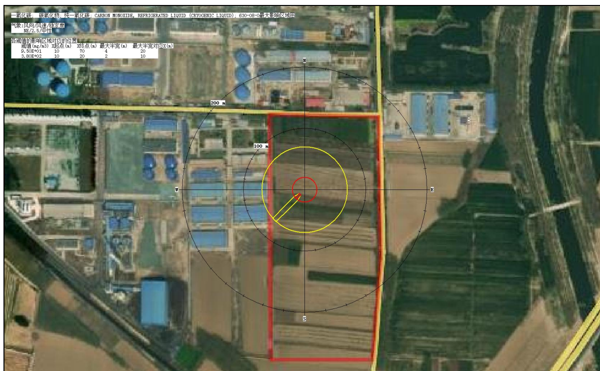
图 6.7-12 最常见气象条件下丙类仓库火灾事故 CO 最大影响范围图
