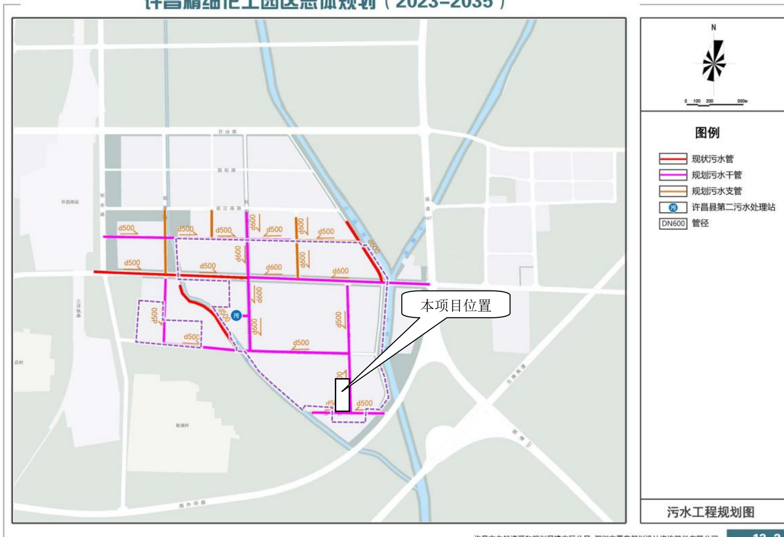
附图五 本项目园区污水管网衔接图
