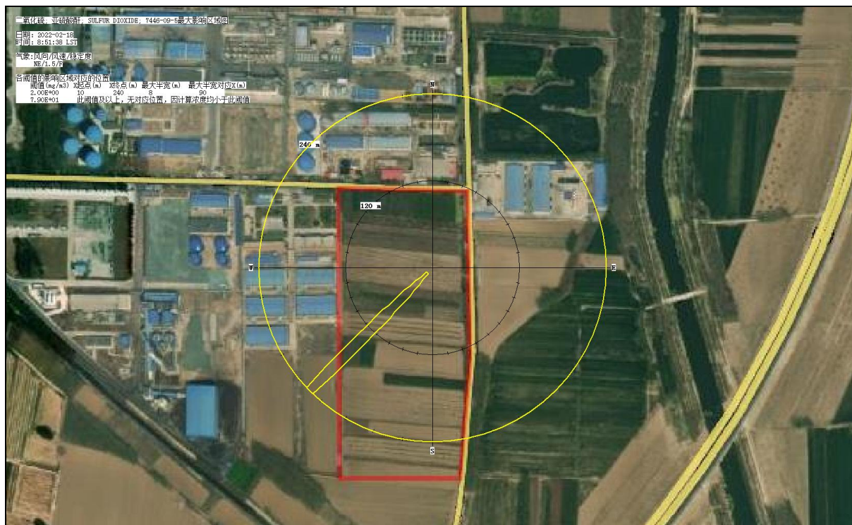
图 6.7-4 最常见气象条件下反应釜 SO 2 泄漏事故最大影响范围图
