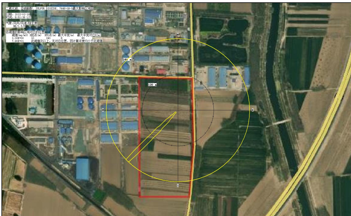
图 6.7-2 最不利气象条件下反应釜 SO 2 泄漏事故最大影响范围图
