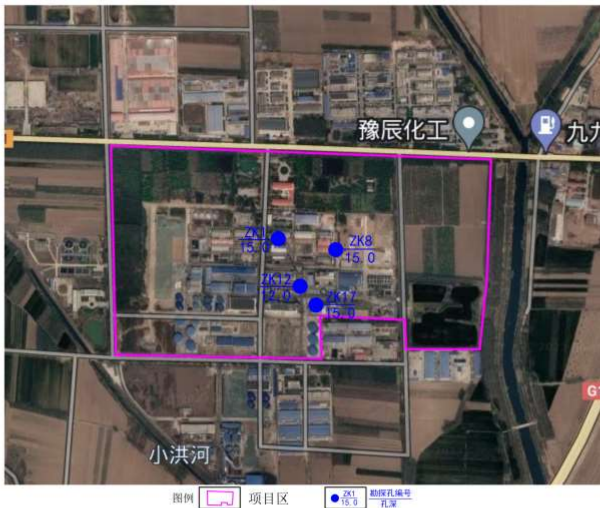
图 5.3-8 项目场地部分勘探孔位置图
