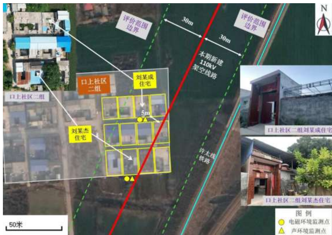
图 15 新建 110kV 线路与环境敏感目标相对位置关系示意图：口上社区二组
