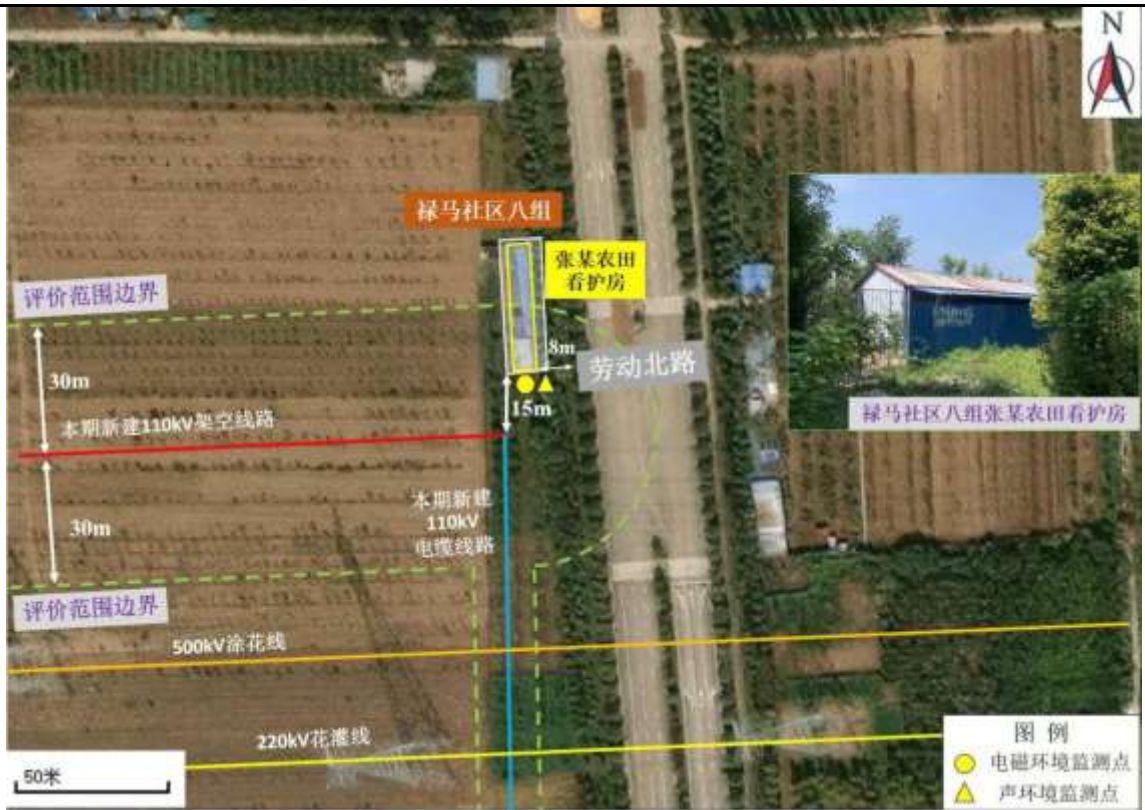
图 16 新建 110kV 线路与环境敏感目标相对位置关系示意图：禄马社区八组
