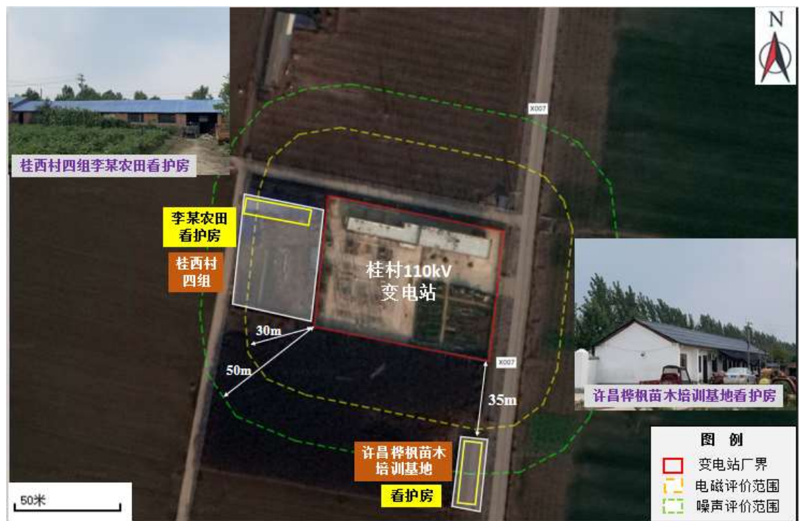
图 17 桂村 110kV 变电站与环境敏感目标相对位置关系示意图
