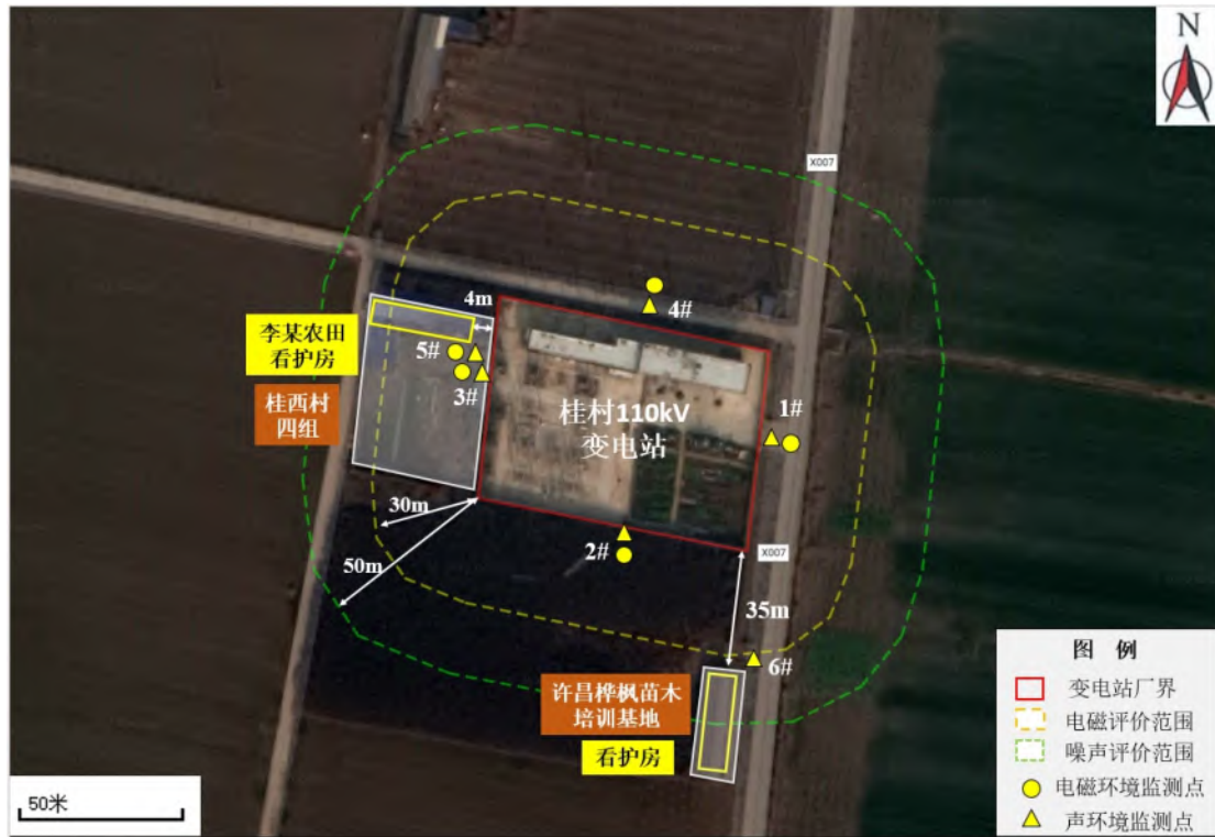
图 3 桂村 110kV 变电站厂界及电磁环境敏感目标监测布点示意图
