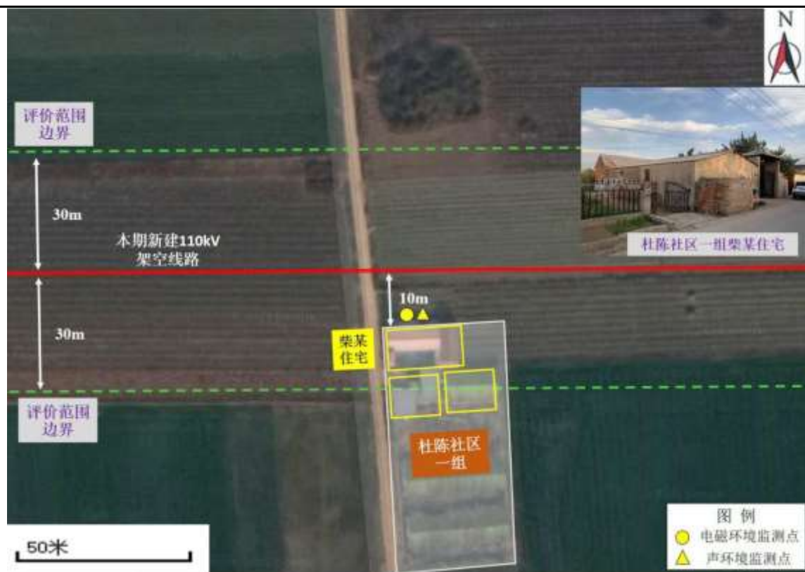
图 14 新建 110kV 线路与环境敏感目标相对位置关系示意图：杜陈社区一组
