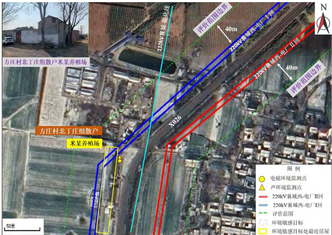
图 14 新建襄城西~莲城电厂 220kV 线路工程与环境敏感目标相对位置关系示意图：方庄村北丁庄组散户
