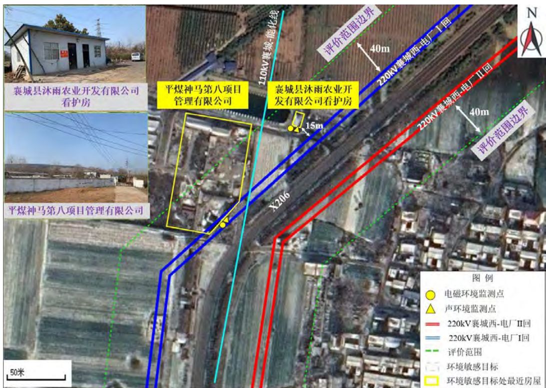
图 16 新建襄城西~莲城电厂 220kV 线路工程与环境敏感目标相对位置关系示意图：襄城县沐雨农业开发有限公司、平煤神马第八项目管理有限公司
