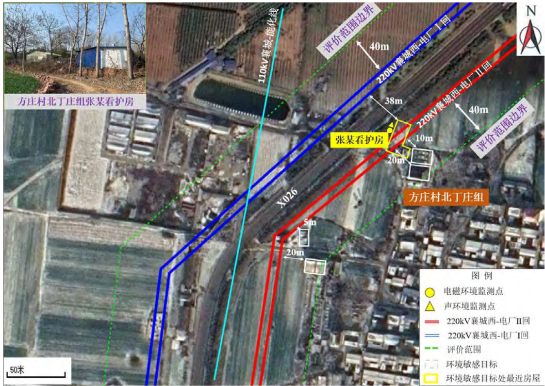
图 15 新建襄城西~莲城电厂 220kV 线路工程与环境敏感目标相对位置关系示意图：方庄村北丁庄组
