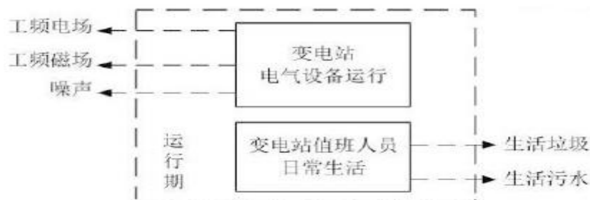
图 2 升压站运行工序及产污环节流程图
