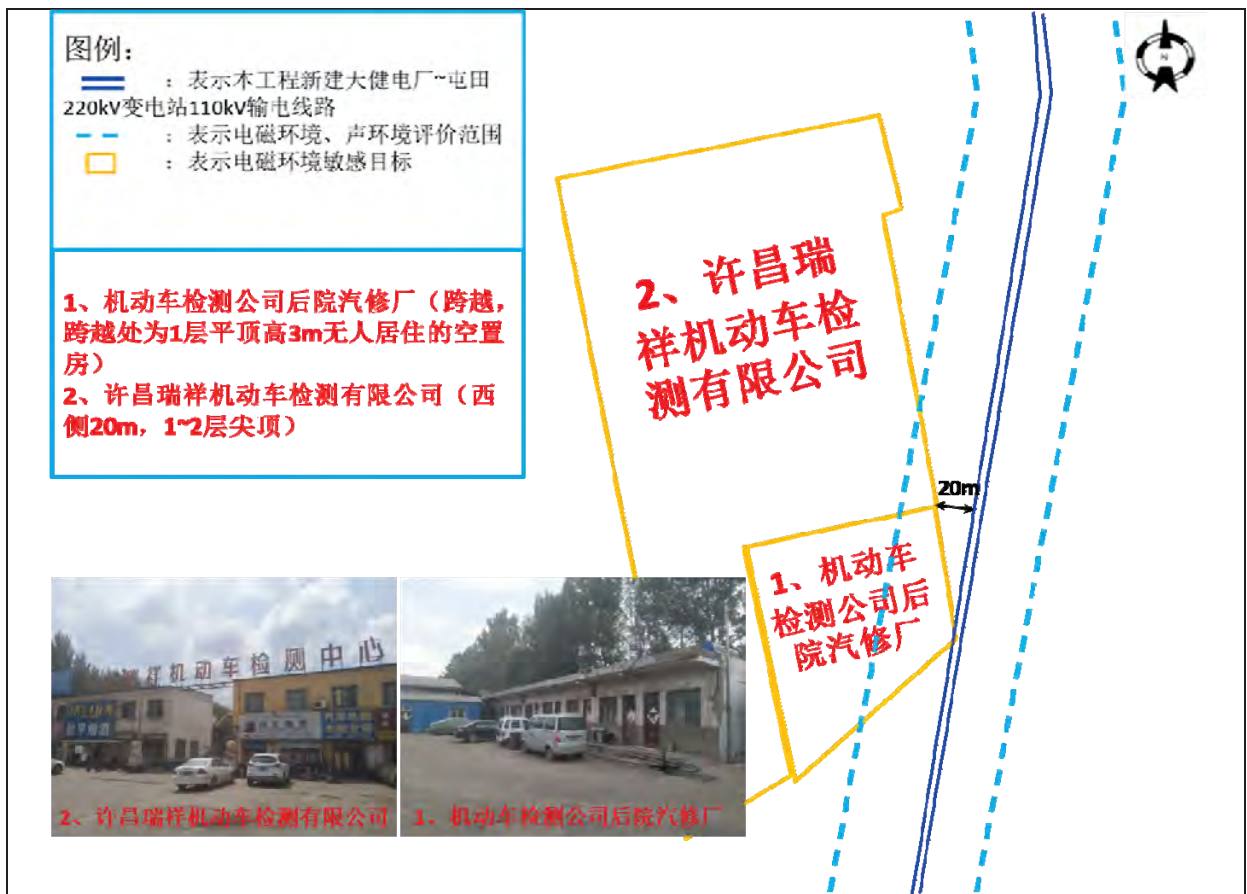
图 4-2 本工程 110kV 输电线路与机动车检测公司后院汽修厂和许昌瑞祥机动车检测有限公司相对位置关系示意图
