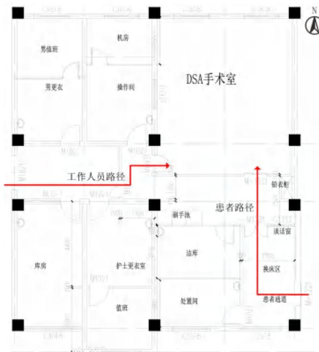
图 9-3 老院区 DSA 机房路径规划图
