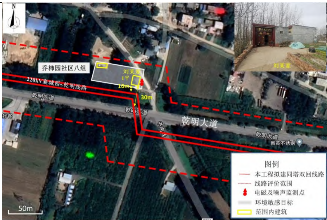
图 33 新建 220kV 线路与环境敏感目标相对位置关系示意图：乔柿园社区八组
