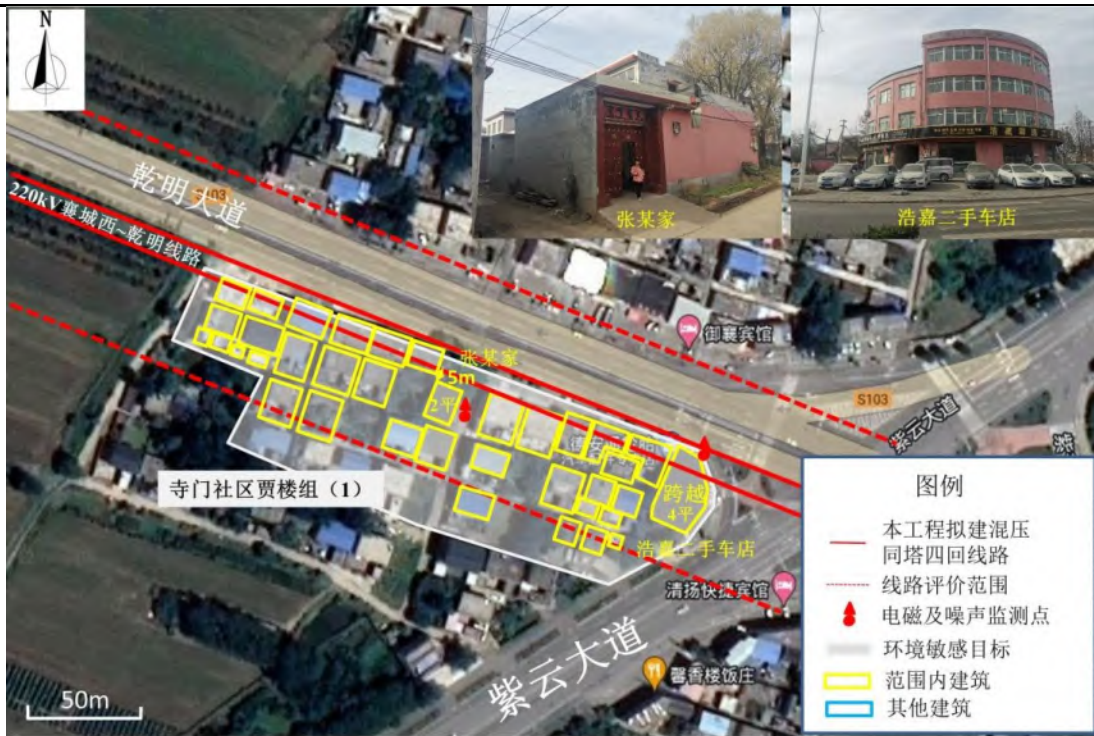
图 31 新建 220kV 线路与环境敏感目标相对位置关系示意图：寺门社区贾楼组（1）
