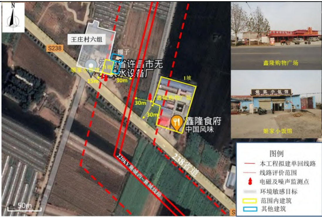
图 25 新建 220kV 线路与环境敏感目标相对位置关系示意图：鑫隆购物广场、王庄村六组
