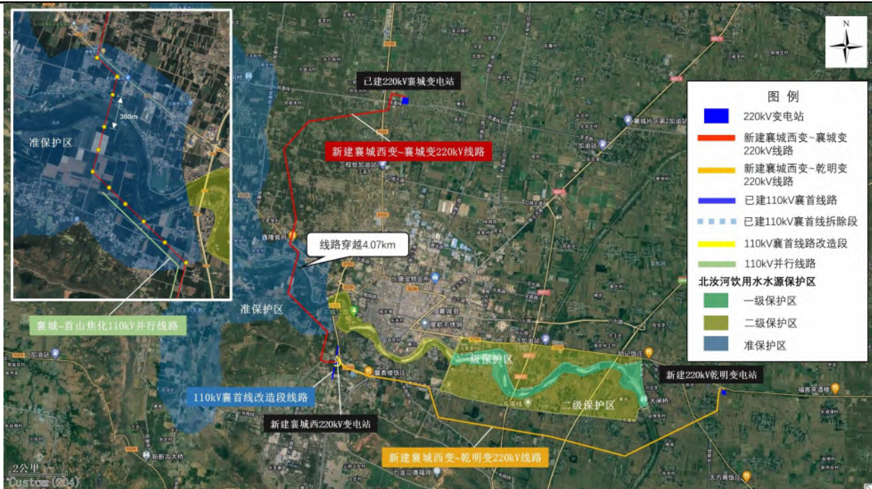
图 50 本工程与许昌市北汝河饮用水水源保护区位置关系示意图
