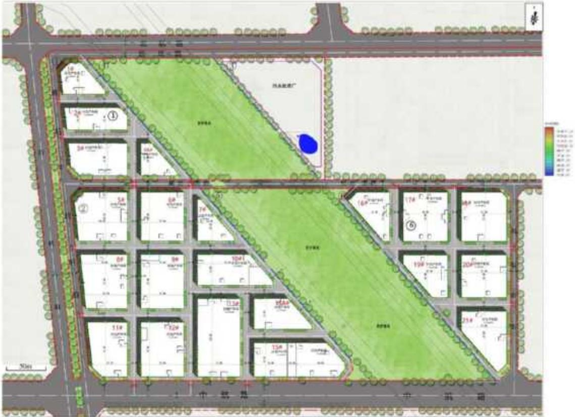
图 4.1-16 COD 对潜水含水层的影响范围图（100d）
