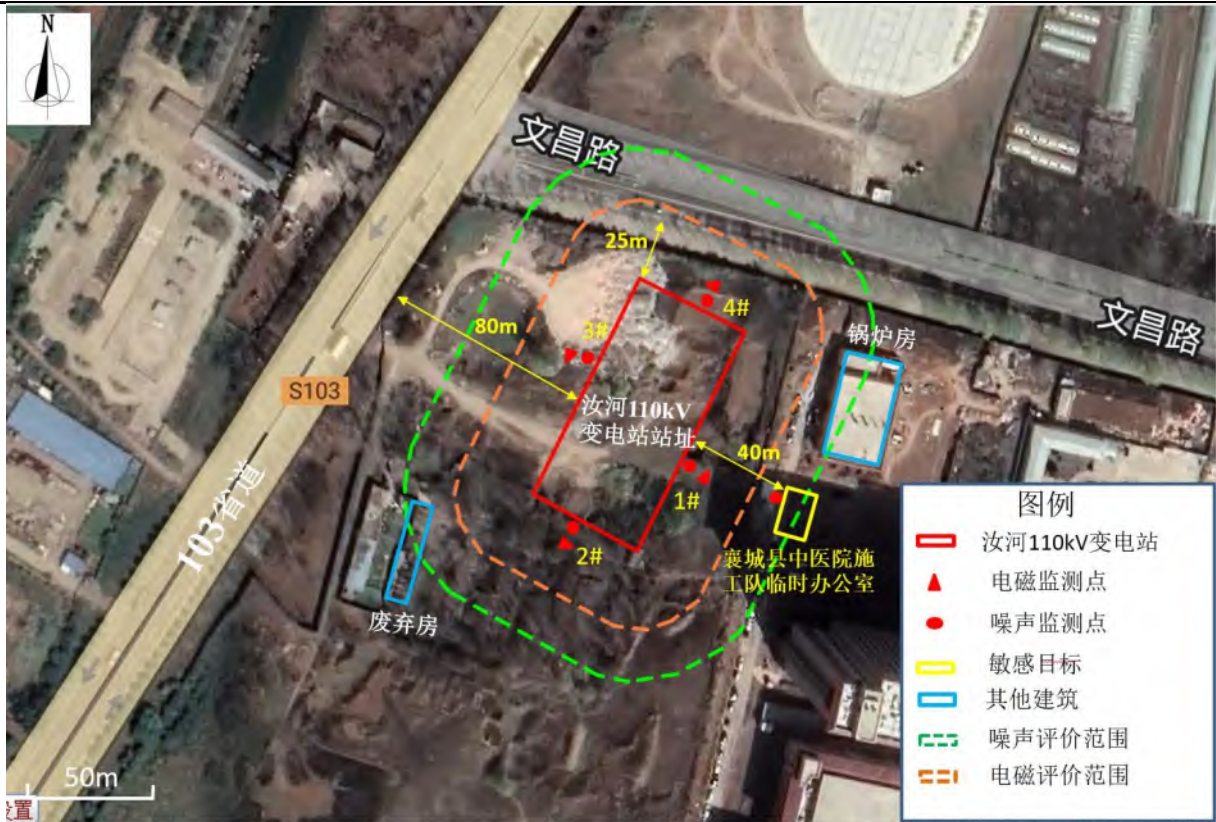
图 16 新建汝河 110kV 变电站与环境敏感目标相对位置关系示意图
