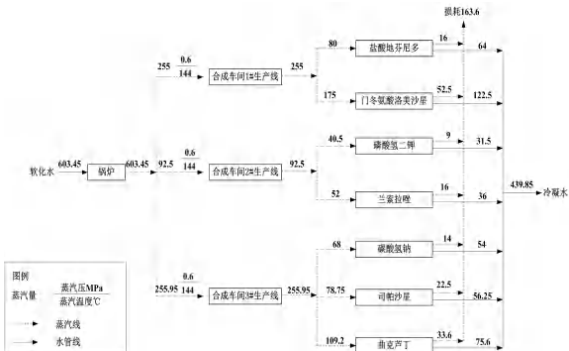
图 2.2-3 现有工程蒸汽平衡图 (t/a)
