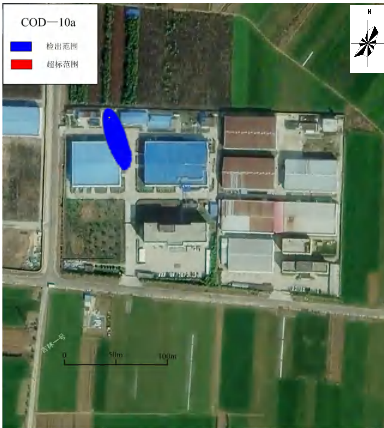
图 5.4-19 非正常状况下调节池泄漏（10a）COD 检出范围及超标范围示意图
