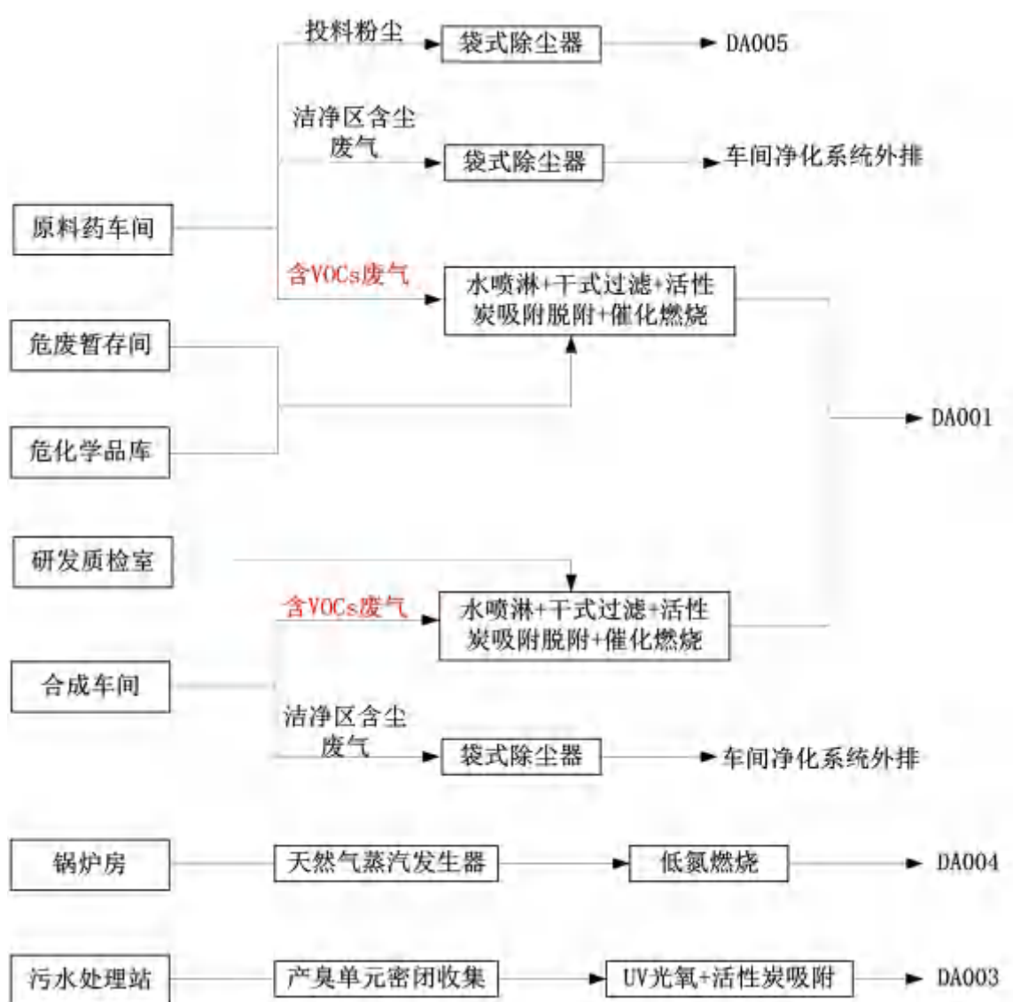
图 6.2-1 全厂废气收集处理及排放去向意图
