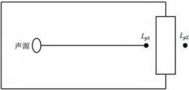
图 4.5-1 室内声源等效为室外声源图例
