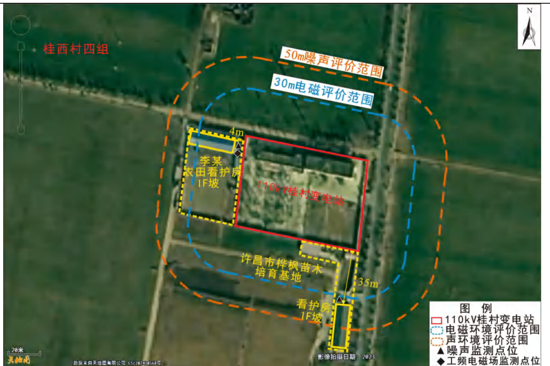
图 3-1-1 110kV 桂村变电站间隔扩建侧现状示意图
