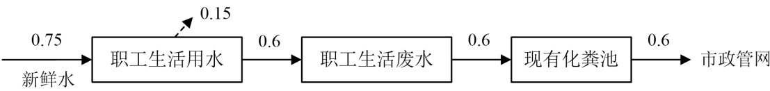
图 2-1 水量平衡图 单位：m³/d
