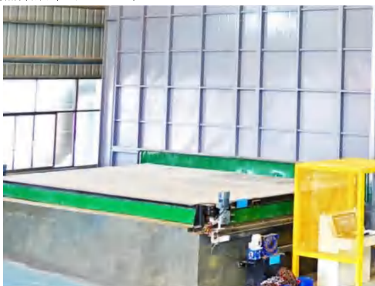
图 6.1-1 酸洗房进出料移动罩示意图
