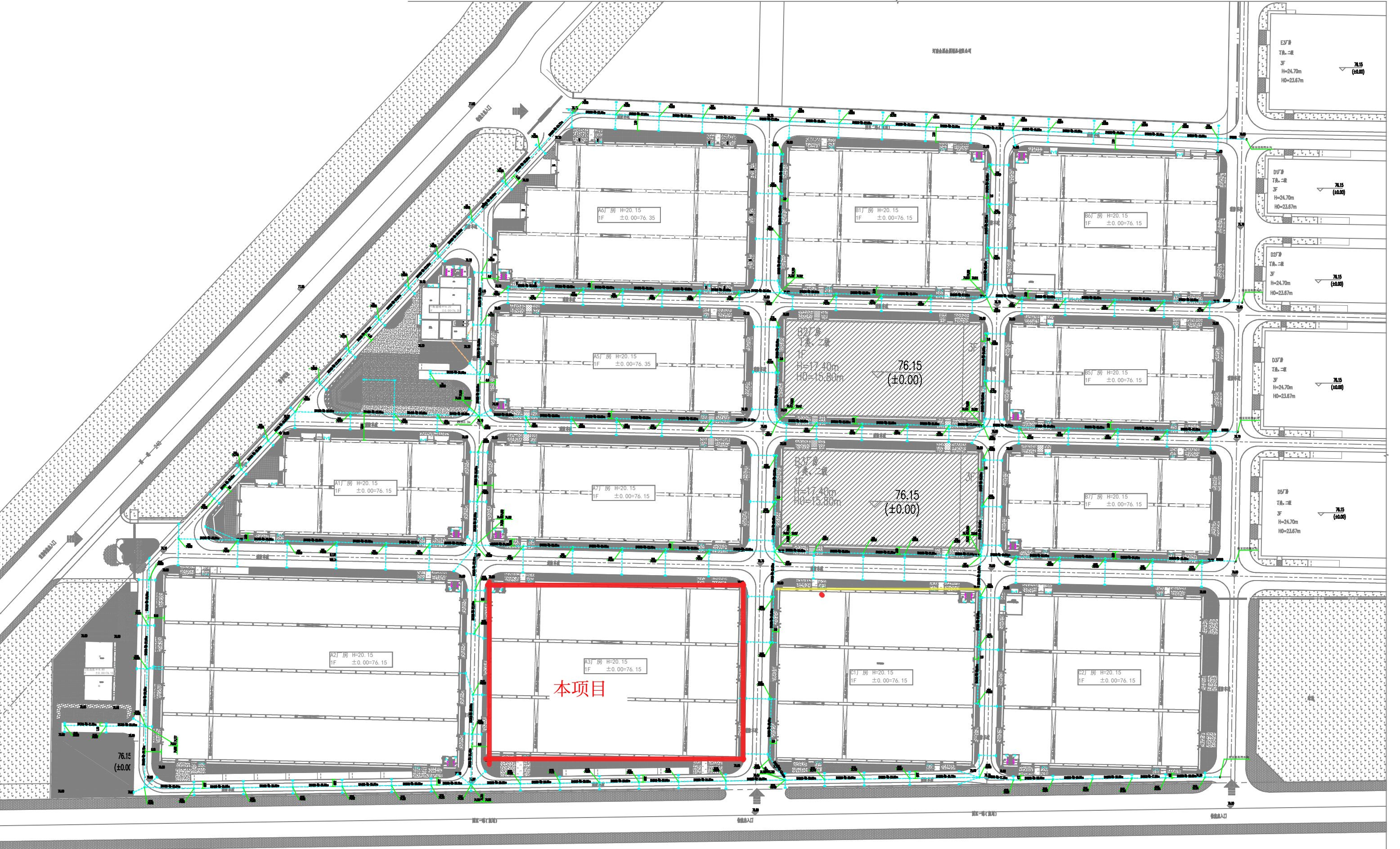
室外雨水总平面图 1:600
