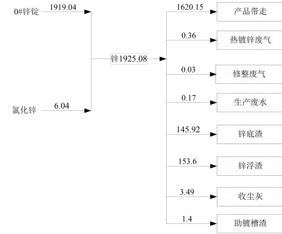
图 2.2-3 锌平衡图 单位 t/a
