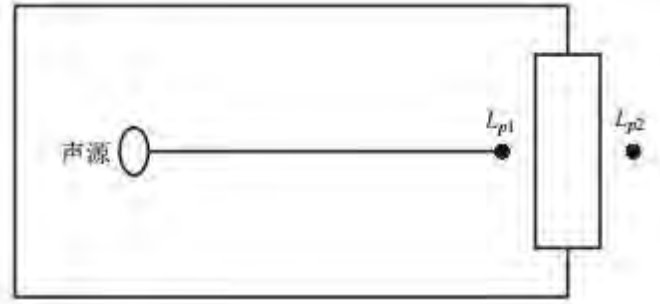
图 4.5-1 室内声源等效为室外声源图例
