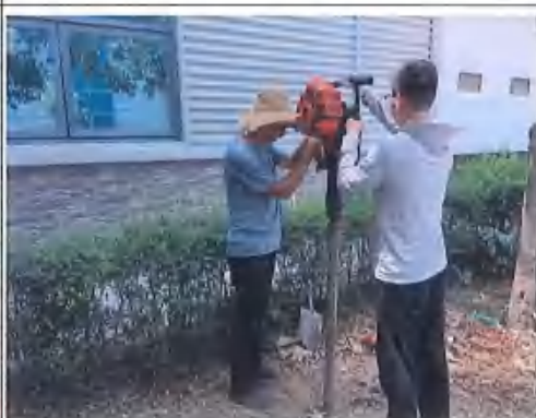
土壤采集现场照片 (3)
