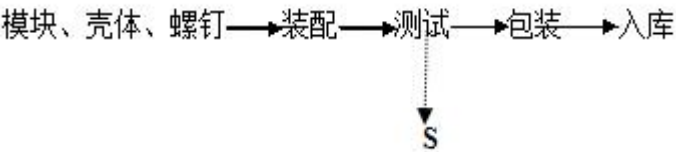
图 2-7 智能电能仪表生产工艺流程及产污环节图
