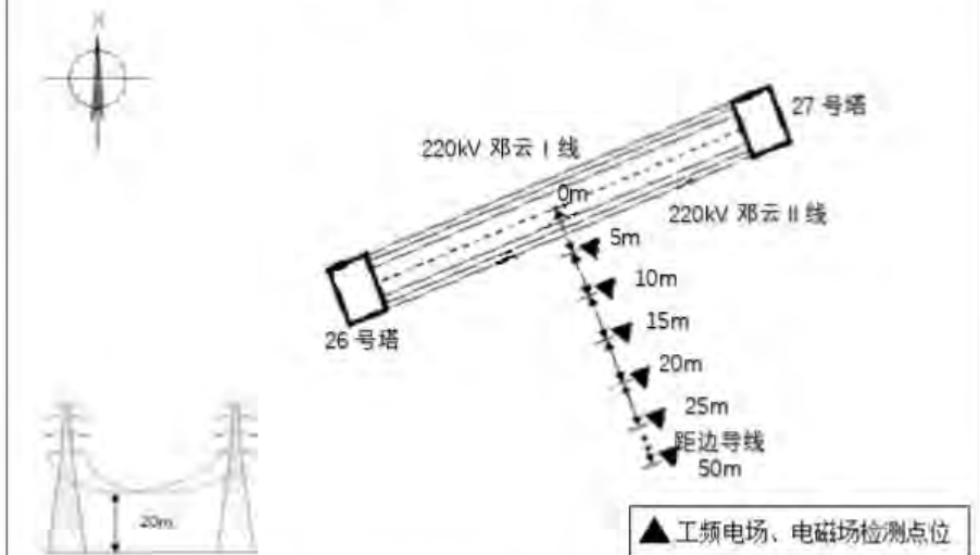
图 7-3 220 千伏邓云线监测布点示意图
