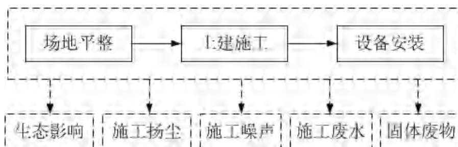
图 4-1 工程施工期主要产污环节示意图
