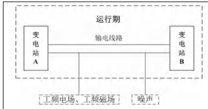
图 4-3 输电线路运行期主要产污环节示意图
