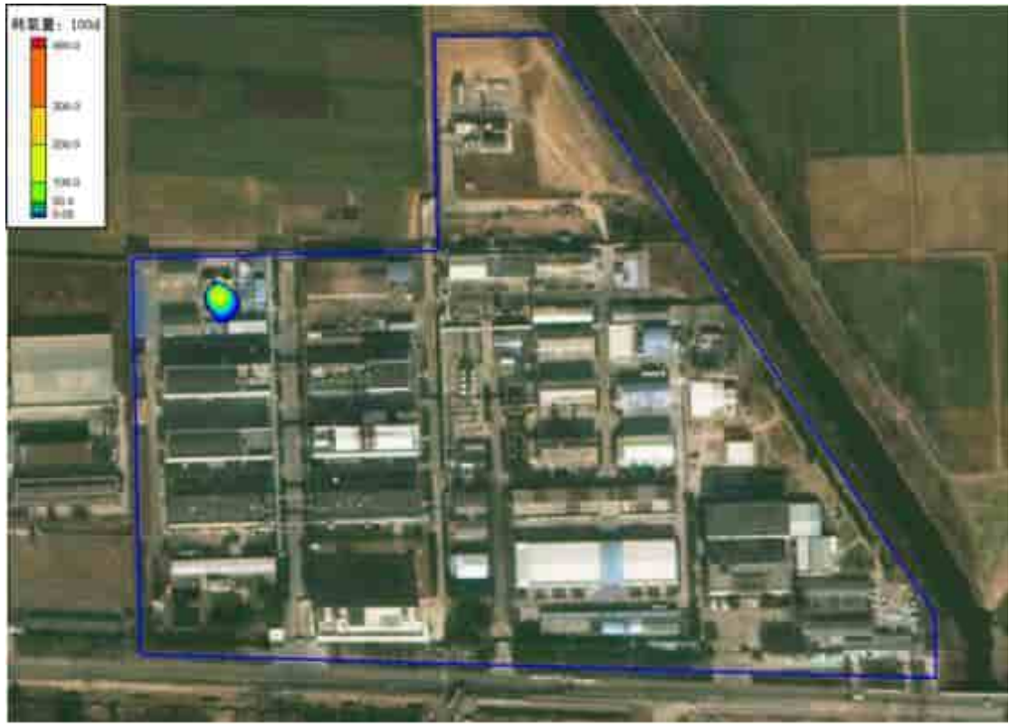
图 5.3-23 耗氧量连续泄露 100d 时的污染羽图
