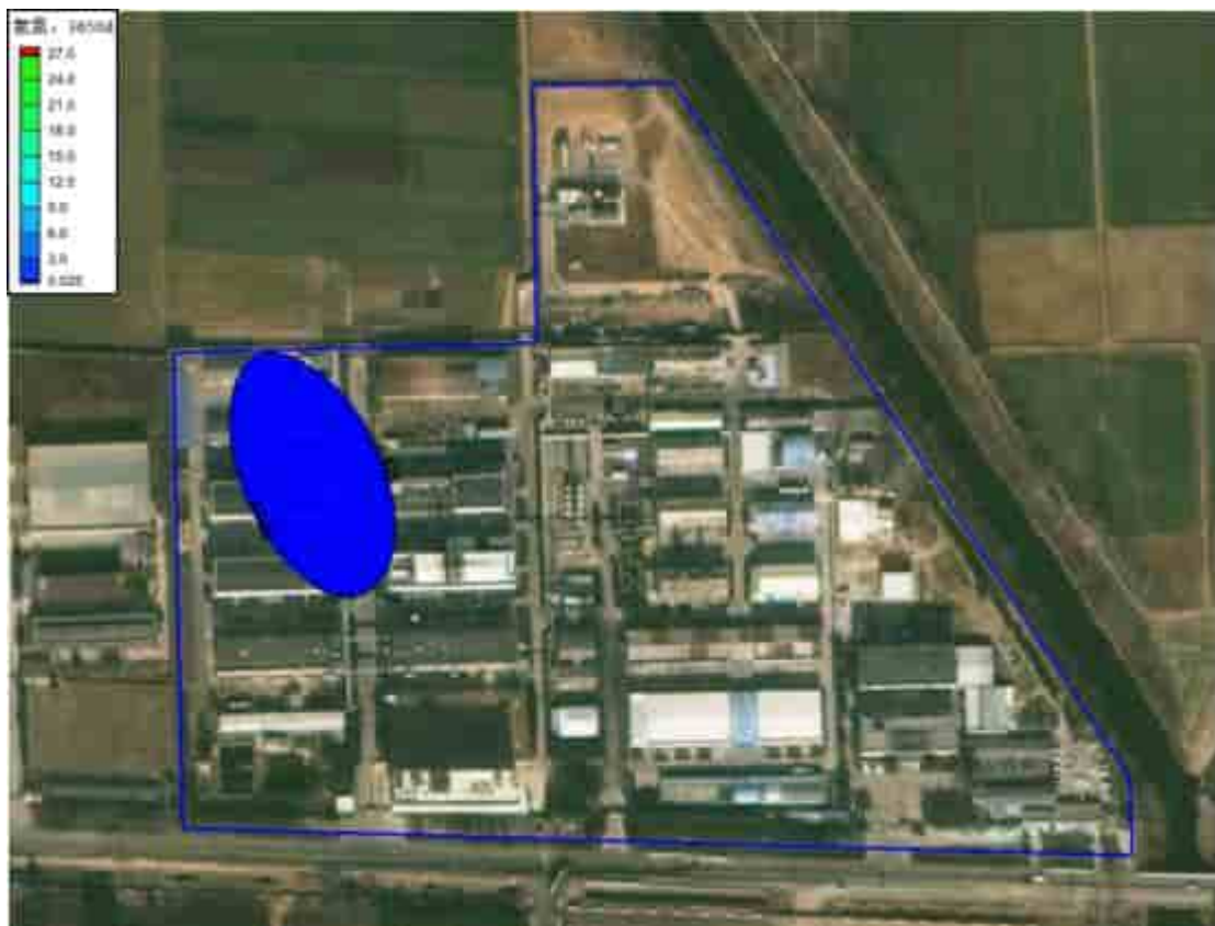
图 5.3-30 氨氮连续泄露 3650d 时的污染羽图
