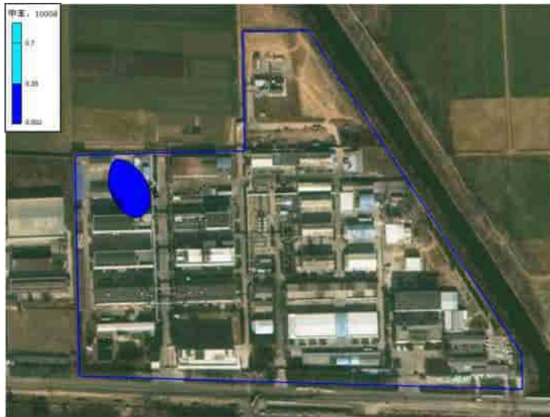
图 5.3-34 甲苯连续泄露 1000d 时的污染羽图
