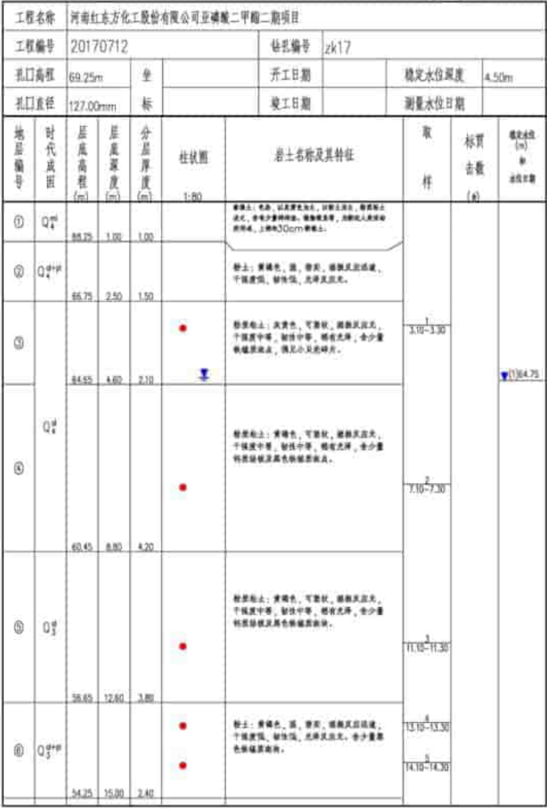
图 5.3-12 ZK17 钻孔柱状图
