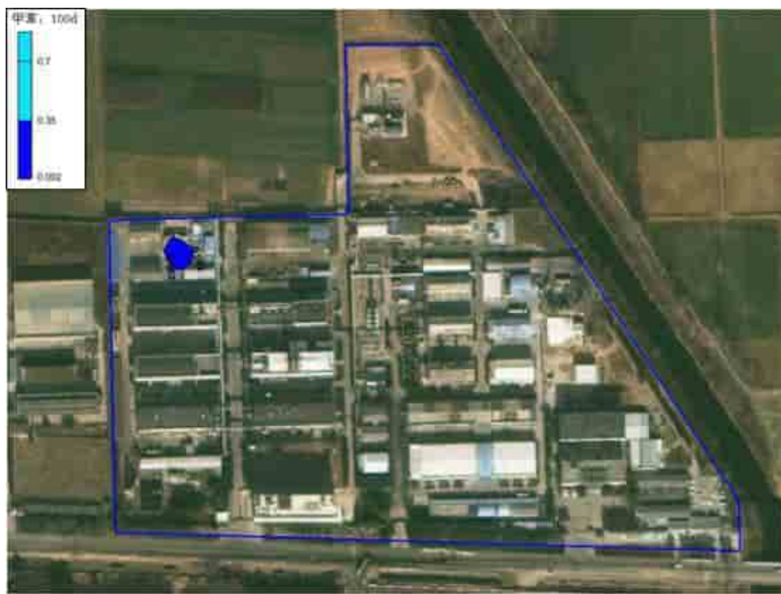
图 5.3-33 甲苯连续泄露 100d 时的污染羽图
