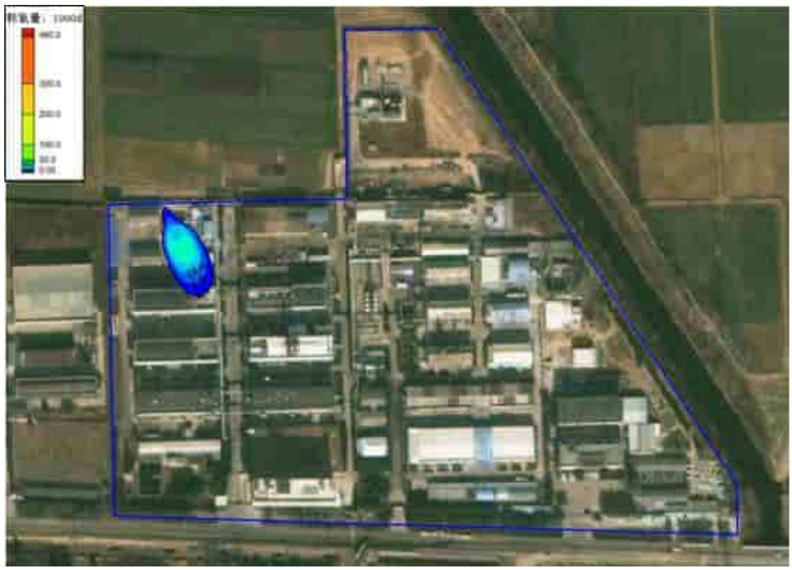
图 5.3-24 耗氧量连续泄露 1000d 时的污染羽图
