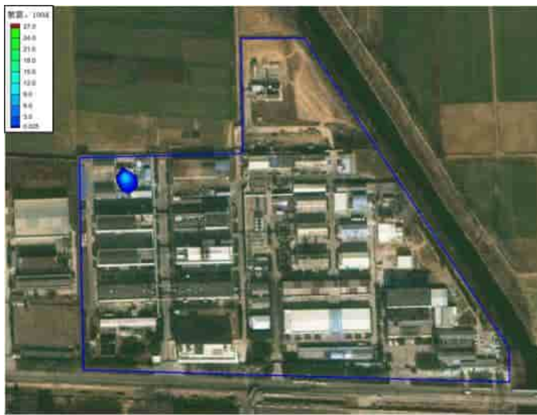
图 5.3-28 氨氮连续泄露 100d 时的污染羽图
