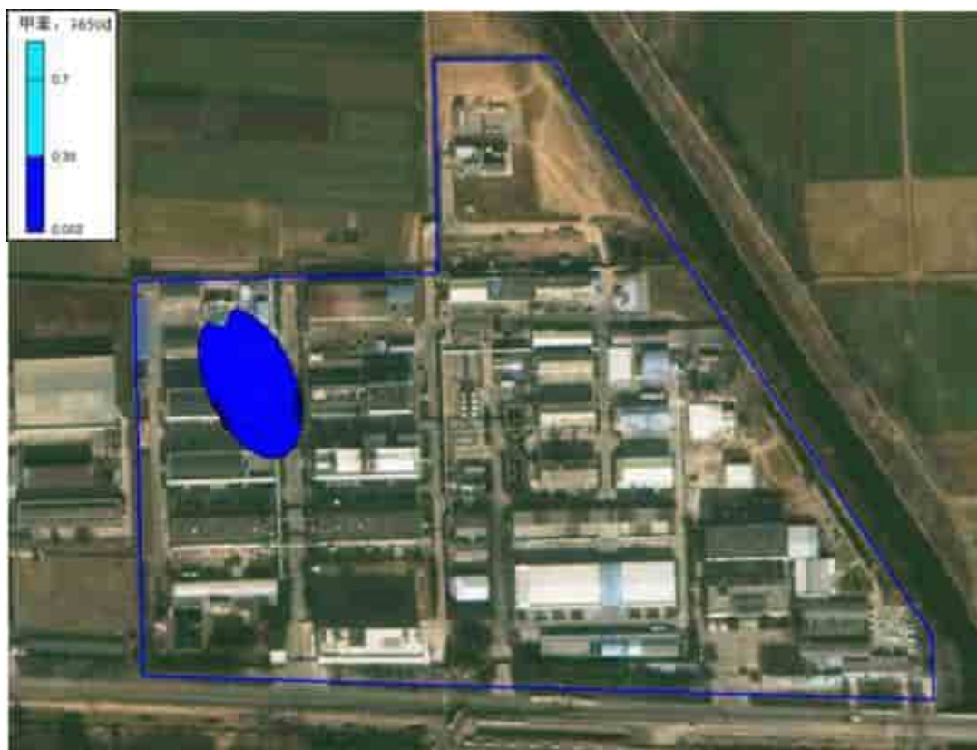
图 5.3-35 甲苯连续泄露 3650d 时的污染羽图
