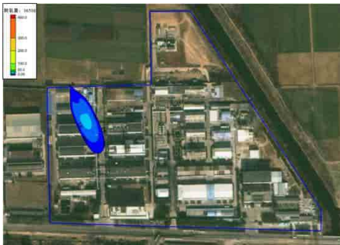
图 5.3-25 耗氧量连续泄露 3650d 时的污染羽图
