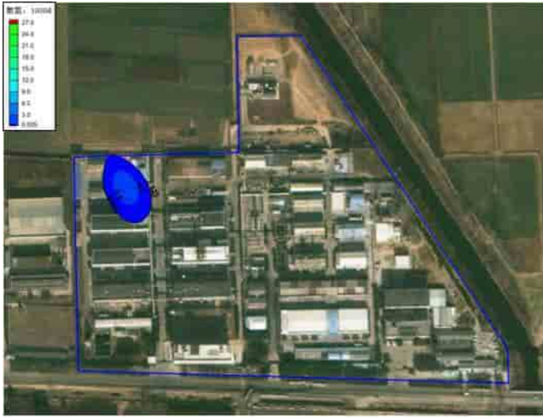
图 5.3-29 氨氮连续泄露 1000d 时的污染羽图
