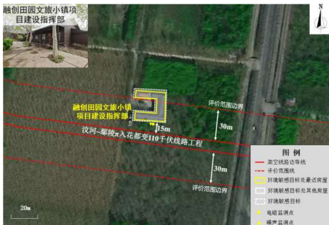
图 20 汶河~鄢陵 \pi 入花都变 110kV 线路与环境敏感目标位置关系及监测布点示意图（河南省许昌市鄢陵县柏梁镇融创田园文旅小镇项目建设指挥部）
