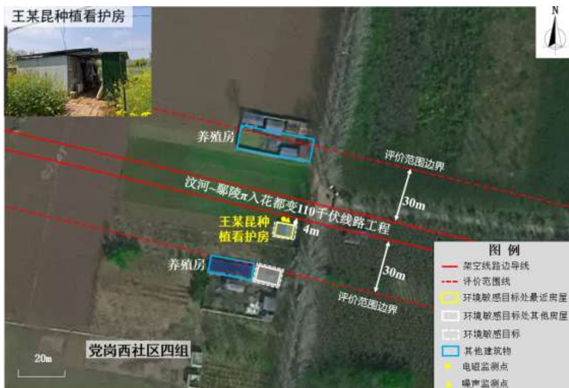
图 19 汶河~鄢陵 \pi 入花都变 110kV 线路与环境敏感目标位置关系及监测布点示意图（河南省许昌市鄢陵县柏梁镇党岗西社区四组散布看护房）
