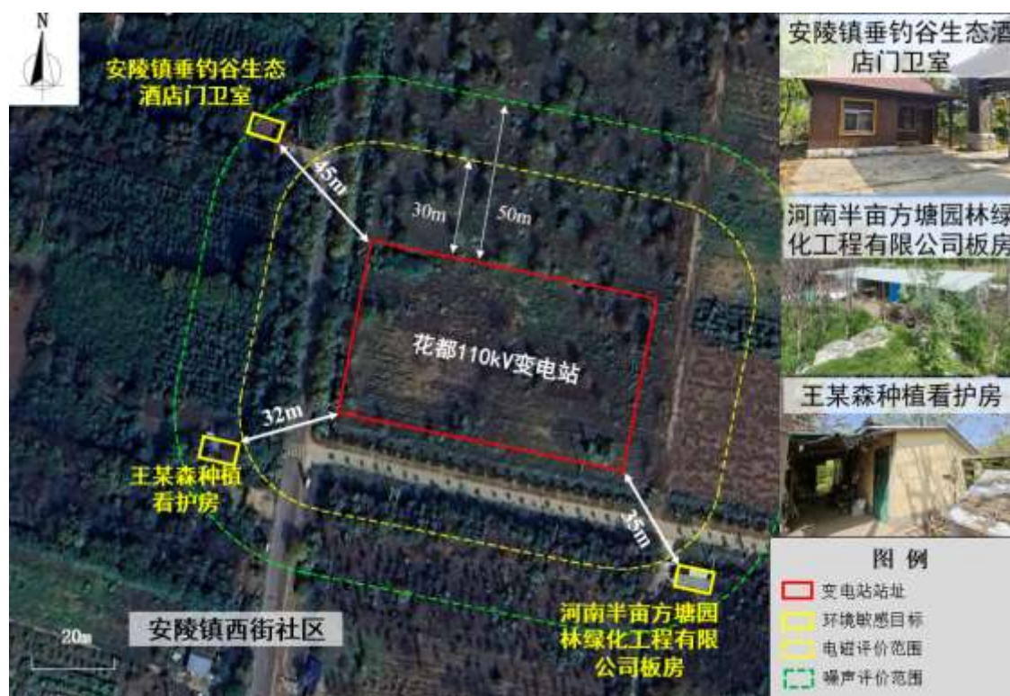
图 16 花都 110kV 变电站与环境敏感目标相对位置关系示意图
