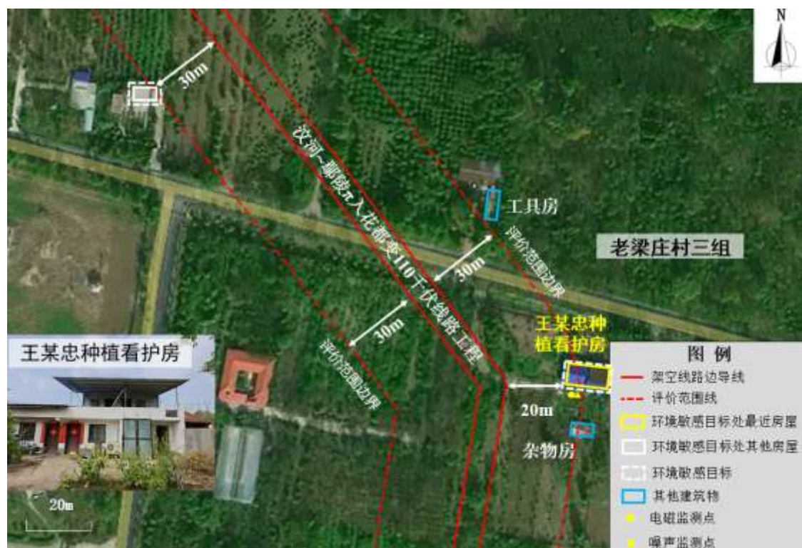
图 21 汶河~鄢陵 \pi 入花都变 110kV 线路与环境敏感目标位置关系及监测布点示意图（河南省许昌市鄢陵县马坊镇老梁庄村三组散布看护房）
