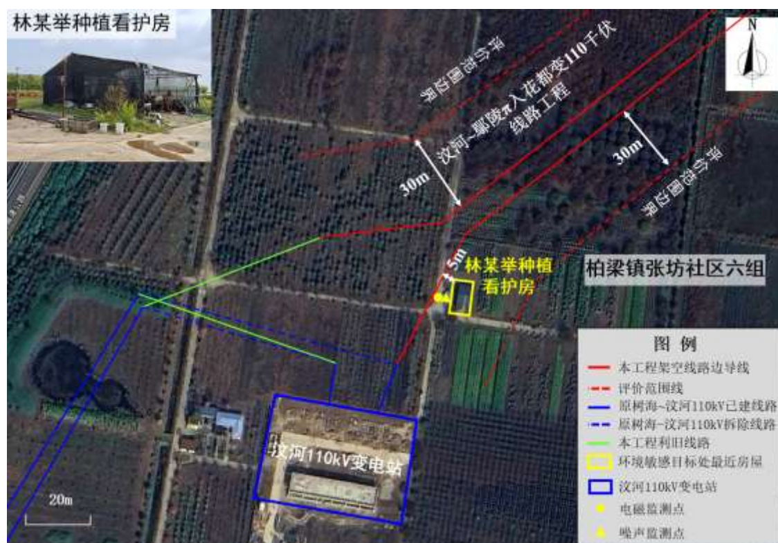
图 17 汶河~鄢陵 \pi 入花都变 110kV 线路与环境敏感目标位置关系及监测布点示意图（河南省许昌市鄢陵县柏梁镇张坊社区六组散布看护房）
