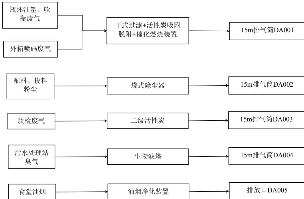
图 5-1 本项目废气治理措施示意图
