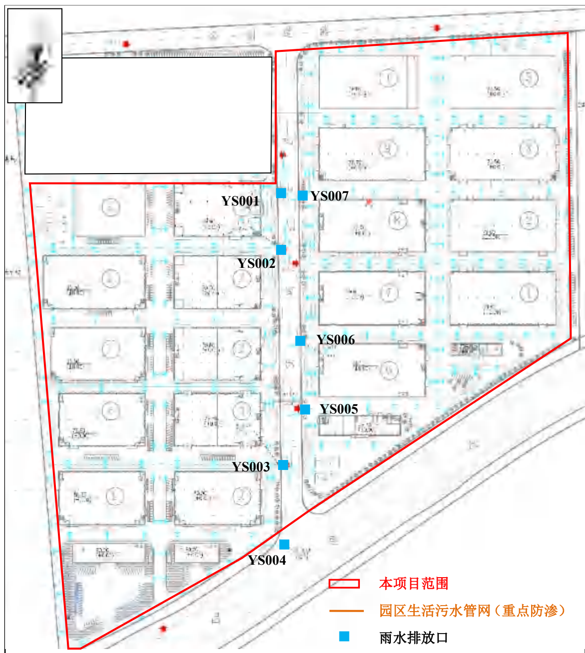
附图 13 本项目雨水管网图
