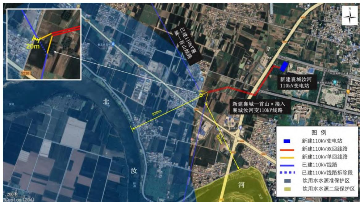
图 9 本工程变电站与北汝河饮用水水源保护区位置关系示意图
