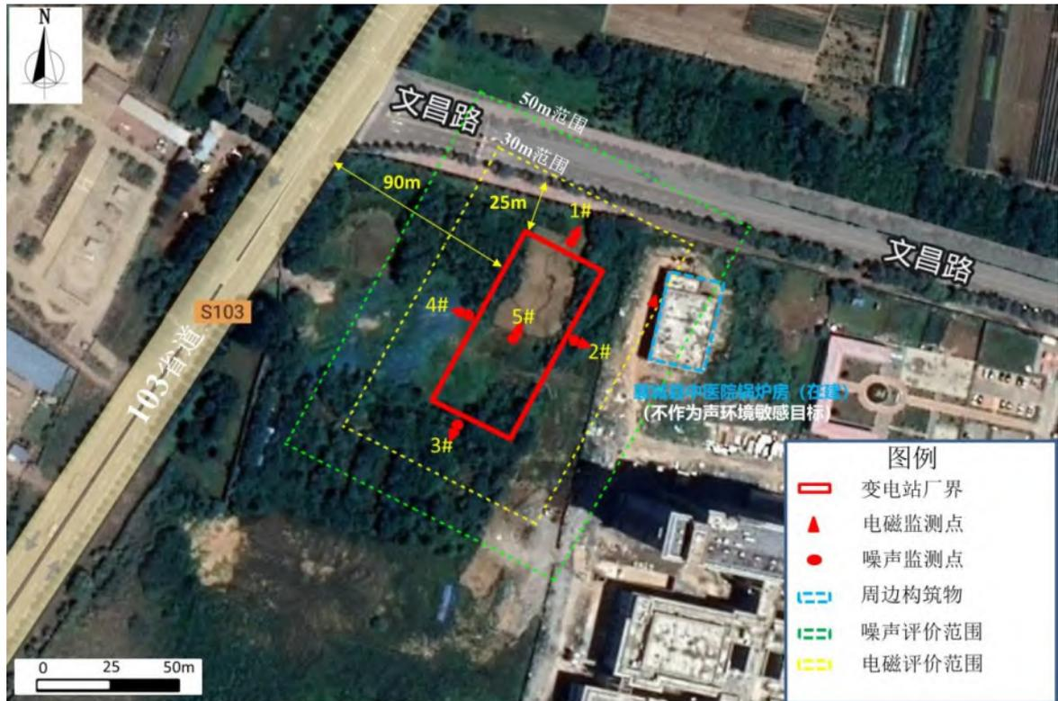
图 8 汝河 110kV 变电站站址监测布点示意图
